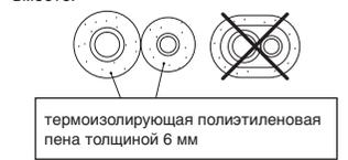
термоизолирующая полиэтиленовая пена толщиной 6 мм
