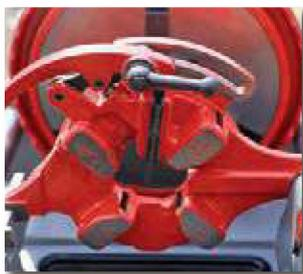
Автоматическая резьбонарезная головка 2.1/2 – 4"
