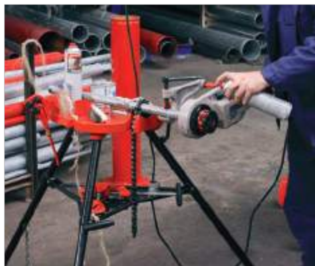
Нарезание резьбы с использованием универсального верстака-треноги
