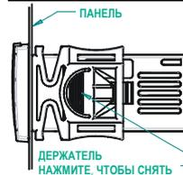
Контроллер XR64CX должен монтироваться на вертикальной панели в вырез 29x71мм и закрепляться, используя поставляемые специальные держатели.
