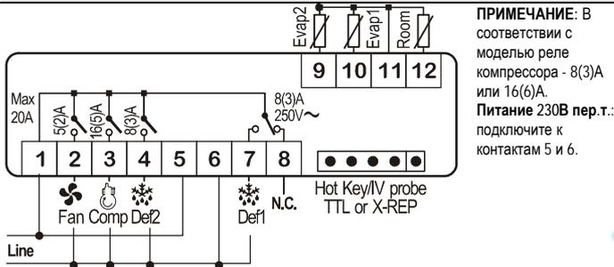
**ПРИМЕЧАНИЕ:** В соответствии с моделью реле компрессора - 8(3)A или 16(6)A. Питание 230В пер.т.: подключите к контактам 5 и 6.
