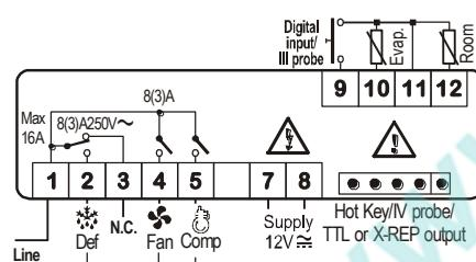
**ПРИМЕЧАНИЕ:** В соответствии с моделью реле компрессора - 8(3)A или 16(6)A.
