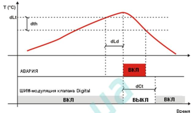
После превышения лимита температуры  $dLt$  в течение времени задержки  $dLd$  производительность компрессора ограничивается параметром  $Cdd$ .
