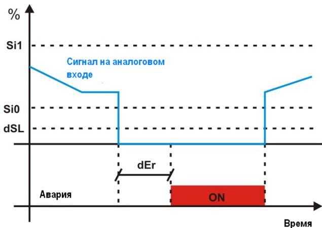
Сброс аварии автоматический и происходит при увеличении сигнала выше параметра dSL. При oA1=CPr регулирование возобновляется по истечении задержки на между двумя последовательными пусками компрессора 2on и между остановкой и последующим запуском компрессора 2oF.
