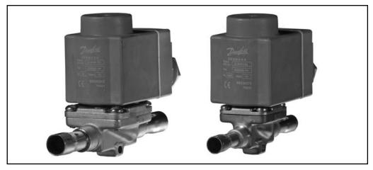
Клапаны типа EVRC – это сервоприводные соленоидные клапаны, устанавливаемые в жидкостные линии холодильных установок, использующих способ оттаивания с помощью горячего газа. При течении жидкости в направлении, противоположном указанному стрелкой на корпусе, перепад давления на клапане будет минимальным.
