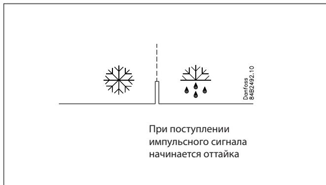
Все упомянутые способы включения оттайки можно использовать произвольно. При активации одного из них начинается оттайка. При включении оттайки таймер сбрасывается на 0.
