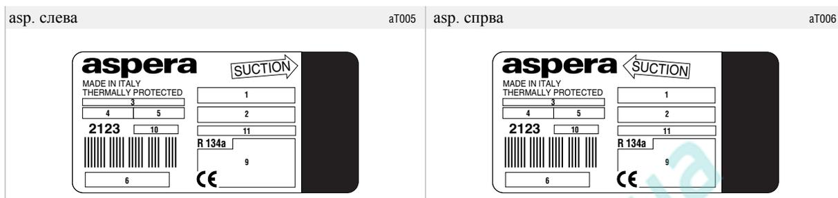
рис. 4 Клейкие Таблички компрессоров серии BP (Используемые до 2004)
