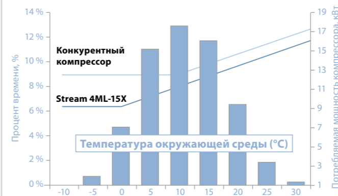
Рисунок 3: Температурный профиль в Брюсселе и потребляемая мощность одного компрессора с учетом условий окружающей среды (Stream 4ML-15X с хладагентом R404A).
