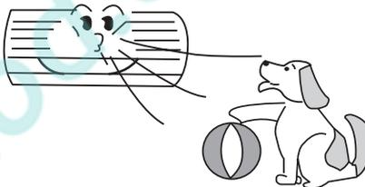
**Потрапляння води на повітряний кондиціонер, може привести до ураження електричним струмом і порушення роботи пристрою.**
