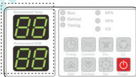
На ЖК экране будет отображаться текущая температура и влажность.
